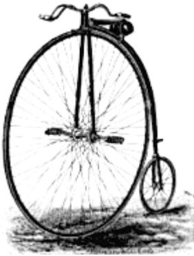
On cherche alors à rendre le vélocipède plus rapide. Comme les pédales étaient fixées de part et d'autre du moyeu de la roue avant, il fallait augmenter le diamètre de cette roue motrice pour accroître la distance parcourue à chaque coup de pédale. Alors le diamètre de la roue avant ne cessera d'augmenter tandis que celui de la roue arrière diminuait son rôle se limitant à permettre l'équilibre de l'ensemble. Ainsi naquit le grand bi dans les années 1870.
